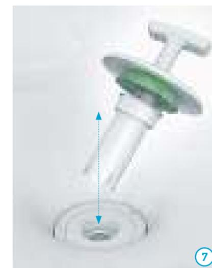
Die Wartung von Architec Dry ist kinderleicht: Sobald sich das grüne, biologisch abbaubare Gel des reinigungsaktiven Dufttrings vollständig aufgelöst hat, muss die Membran erneuert werden. Dazu dient ein separater Schlüssel, mit dem sich das entsprechende Modul per Bajonettverschluss bequem austauschen lässt **(5-7)**.
