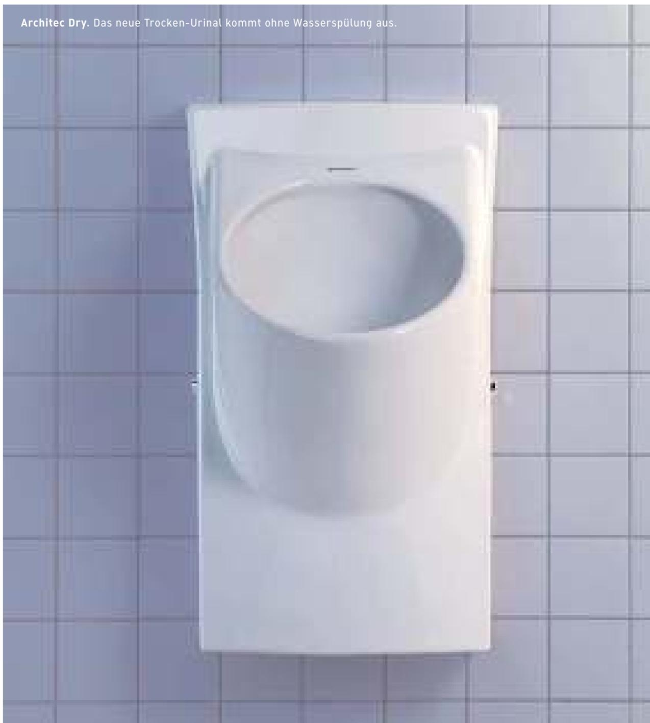
Das neue Trocken-Urinal kommt ganz ohne Wasserspülung aus. Der Trick ist eine im Ablauf integrierte Schlauchmembran: Diese öffnet sich nur beim Durchfluss des Urins **(1)** und verschließt sich danach wieder **(2)** – automatisch, geruchsdicht und verdeckt von einer formschönen Abdeckung mit Dufttring **(3)**. Alternativ dazu ist das Urinal auch ohne Abdeckung lieferbar. **(4)**
