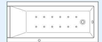
**Jet-System.** 6 in der Seitenwand angeordnete Wasser-Luft-Düsen erzeugen eine wohltuende Massagewirkung. Die Intensität des Massagestrahls wird über einen auf dem Wannrand angebrachten Luftregler gesteuert. Das Jet-System kann individuell um die Zusatzmodule LED-Farblicht und Sound erweitert werden.
