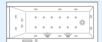
**Combi-System L.** Die Bedieneinheit leuchtet bei Berührung blau auf. Die serienmäßig enthaltenen Systeme Air, Jet sowie der Halogenspot (bei Blue Moon 2 Spots), die Rücken- und Fußmassage lassen sich auf einer kompakten Fläche einfach und komfortabel bedienen. Die serienmäßige Ausstattung umfasst zudem einen elektronischen Trockenlaufschutz. Das Combi-System L kann individuell um die Zusatzmodule LED-Farblicht (S. 170), Temperatur L sowie das automatische UV-Hygienemanagement erweitert werden.
