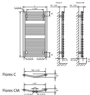
**BESCHREIBUNG:** Flores, Flores M mit geraden, Flores C, CM mit gebogenen waagerechten Präzisionsstahlrohren 22 x 1 mm und senkrechten D-Profil-Sammelrohren 40 x 30 x 1,5 mm
